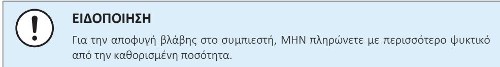
**Προαπαιτούμενο:** Πριν από την πλήρωση ψυκτικού, βεβαιωθείτε ότι έχετε συνδέσει και ελέγξει τη σωλήνωση ψυκτικού (δοκιμή διαρροής και αφύγρανση κενού).
